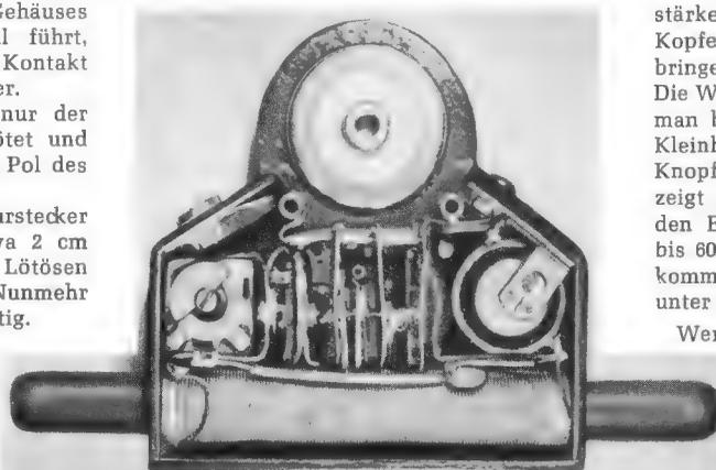
Bild 10. Mikro-Empfänger offen, ohne Stetoclip in natürlicher Größe
