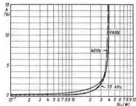
Bild 3. Klirrfaktor des Saturn 573 mit „eisenloser“ Endstufe
