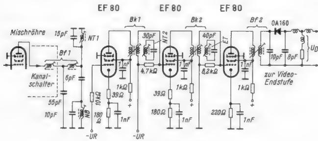
Bild 40. Bild-Zf-Verstärker
