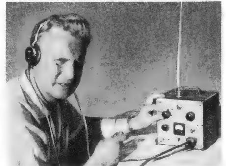
Bild 4. Sende-Empfänger für das 144-MHz-Band zum Betrieb aus Batterien (E. Schäfer, DL 3 ER)
