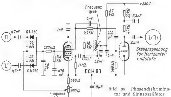
Bild 39. Phasendiskriminator und Sinusoszillator
