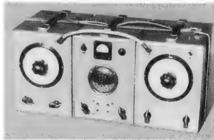
Bild 3. Sende-Empfänger für das 144-MHz-Band zum Betrieb an der Kraftwagen-Starterbatterie oder am Netz (W. Schimmelmann, DL 6 SW)
