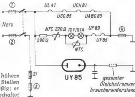
Ein Vorwiderstand für höhere Netzspannungen an den Stellen 1, 2 oder 3 ist unzweckmäßig; er wird besser bei 4 eingeschaltet
