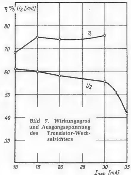
Bild 7. Wirkungsgrad und Ausgangsspannung des Transistor-Wechselrichters
