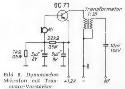
Bild 5. Dynamisches Mikrofon mit Transistor-Verstärker
