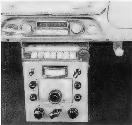
Bild 1. Im Kraftwagen eingebaute Sende/Empfangsanlage für das 80-, 40-, 20-, 15- und 10-m-Band mit Converter als Vorspann für den Autosuper (A. Wittmann, DL 1 HY)
