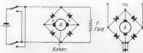
Links: Bild 1. Grundschaltung. Die Stromrichtung im Anker ist unabhängig von der Polung der Spannungsquelle
