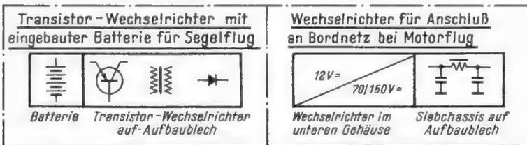
Links: Bild 4. Blockschaltung des Flugfunktensprechgerätes
