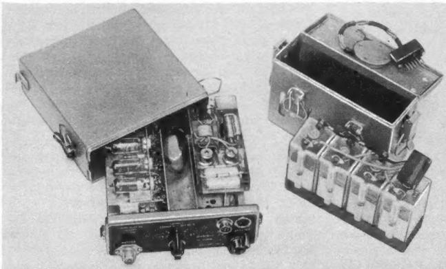
Bild 3. Segelflugausführung des Funkgerätes. Blick auf das Senderchassis und den Transistor-Wechselrichter, rechts das Batterie-Gehäuse
