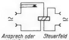
Bild 1. Prinzip des Remanenzrelais
