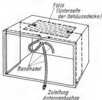
Bild 1. Skizze der UKW-Einbauantenne im Philips-Saturn 573, ein Faltdipol in geknickter Ausführung
