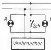
Bild 3. Blinksignal als Schalterstellungs-Anzeiger
