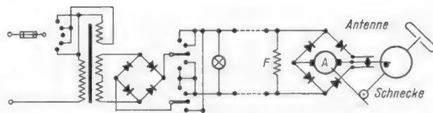
Bild 3. Gesamtschaltung der Antennensteuerung
