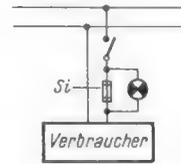
Bild 4. Blinksignal zeigt durchgeschlagene Sicherung an
