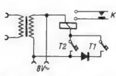
Bild 2. Schaltung eines Remanenzrelais, bei dem der Abfall durch eine Wechselspannung bewirkt wird
