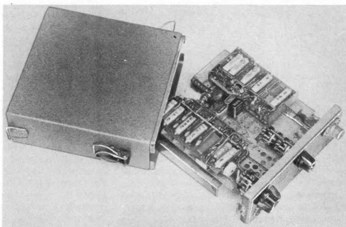
Bild 2. Das geöffnete Gerät mit Blick auf die beiden Bausteine des Empfänger-Chassis (Hf- und Nf-Baustein)
