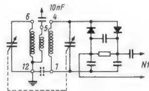
Diodenempfänger mit Spannungsverdopplung und Bandfilter-Eingang
