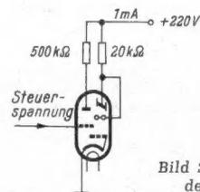
Bild 3. Schaltung der EM 84 in den Schaub-Empfängern
